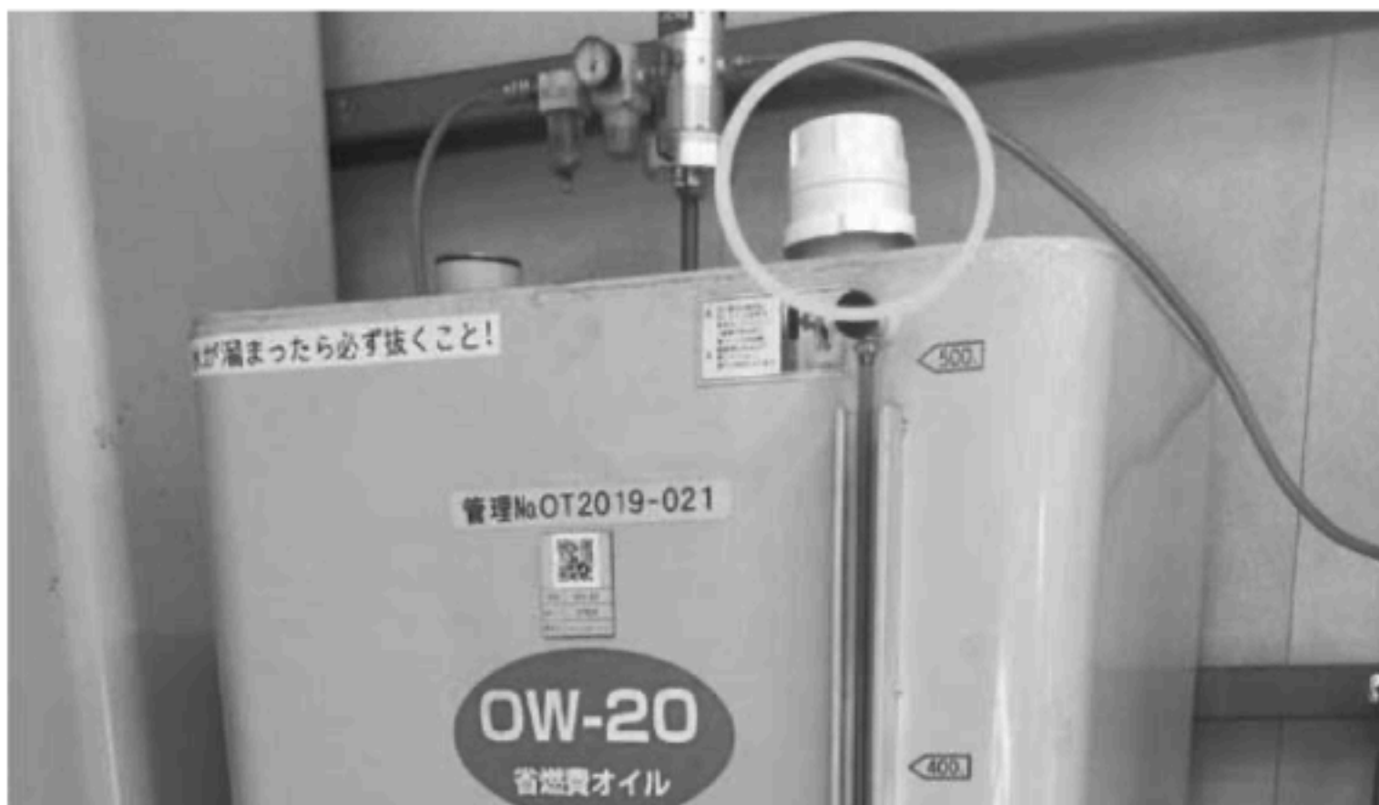
エンジンオイルの貯蔵タンクにキャップ兼センサーを設置。残量を自動計測しクラウドに送信している
