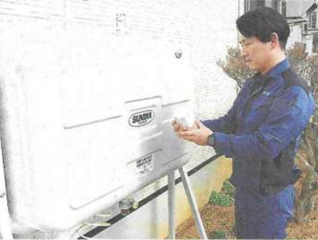
灯油タンクに付けるだけで残量などが把握できるキャップ型の「スマートオイルセンサー」を手にする小松祐一郎社長
